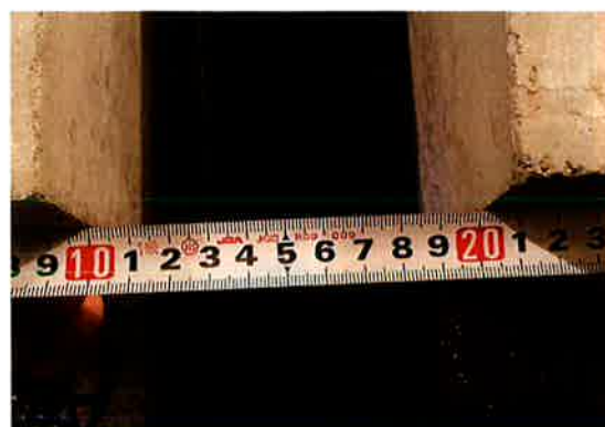
連続試験圧縮時 (+11.25mm)
