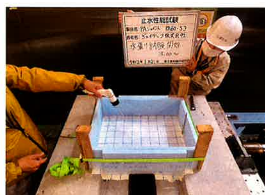
水張り試験開始 (側面)
