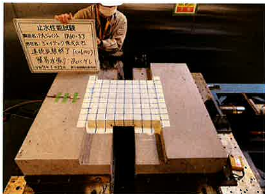
終了時簡易水張り 側面 漏水なし
