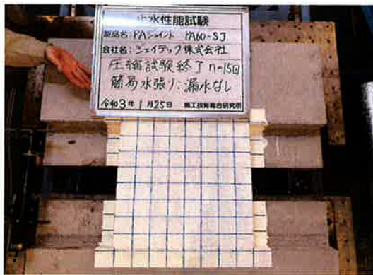
終了時簡易水張り 上面1 漏水なし
